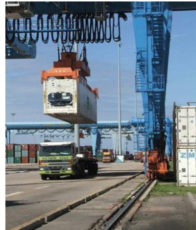
מסילות קרקע של מנוף מכולות. המנוף מנוף מניח את המכולה שהורדה מהאניה על המשאית.
